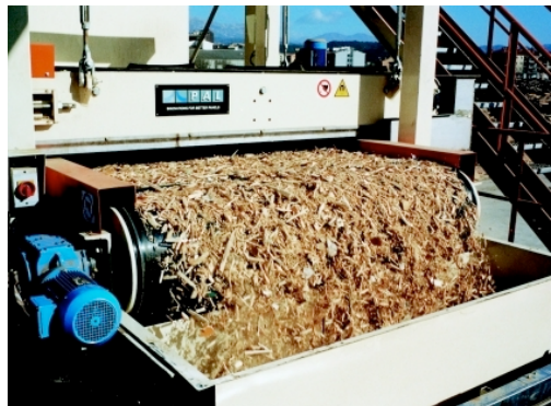
Mágnesezhető és nem mágnesezhető szennyeződések eltávolítása
