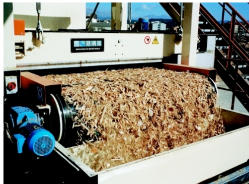
Mágnesezhető és nem mágnesezhető szennyeződések eltávolítása
