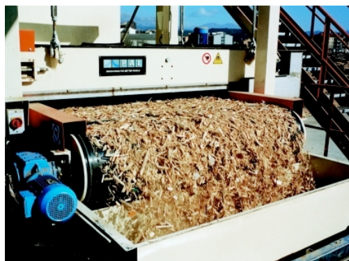
Mágnesezhető és nem mágnesezhető szennyeződések eltávolítása
